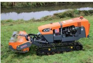
Ferngesteuerte Böschungsmäher bewältigen aufgrund des niedrigen Schwerpunktes steile Böschungswinkel. Nachteilig sind der hohe Preis und die fehlende Steuerungssensibilität durch die Entkopplung zum Fahrer.
