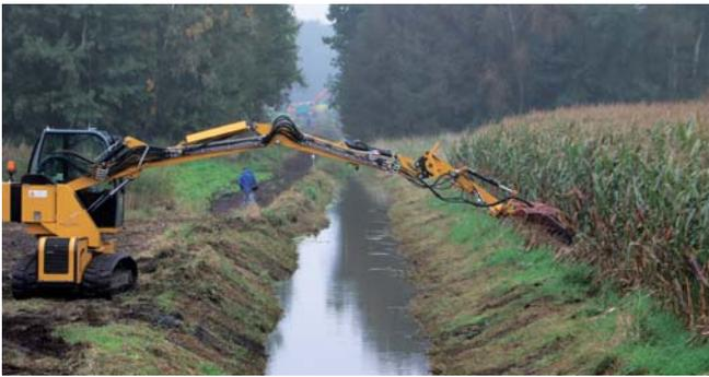
Moderne Systeme (Bild) haben bei minimaler Spurbreite Arbeitsreichweiten von 8,60 m und sind zusätzlich mit einer automatischen Mähkorbführung ausgestattet, die einen Eingriff in das Sediment durch Sohliefenkalibrierung verhindert. Bei Weiterfahrt (automatisch um Mähkorbbreite) korrigiert sich die Maschine selbständig. (Foto: U.A.N.)
