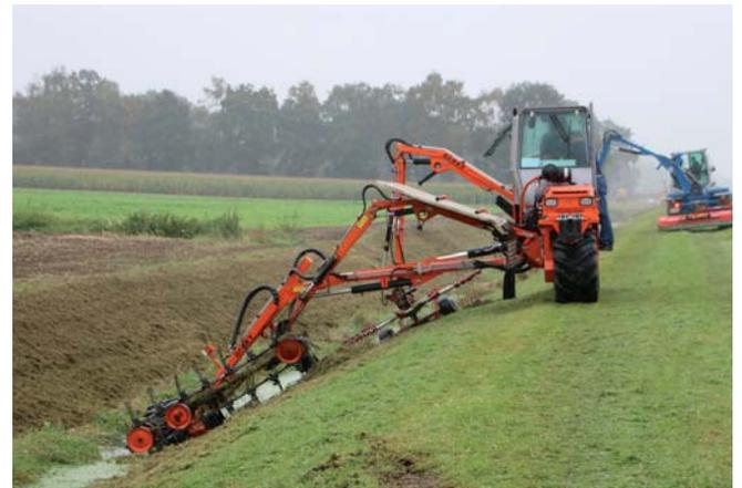
Das Kombinationsgerät mit Messermähbalken und Bandschwader (auch Bandrechen genannt) wird überwiegend bei gehölzfreien Gewässern mit Regelprofil eingesetzt und benötigt sehr wenig Platz auf der Böschungsoberkante. Auch mit diesem Gerät ist es möglich, beispielsweise einen schmalen Ufersaum oder Abschnitte von Röhrichten gezielt stehenzulassen. Im Gegensatz zum Mähkorb ist diese Maschine deutlich wartungsintensiver. (Fotos: U.A.N.)
